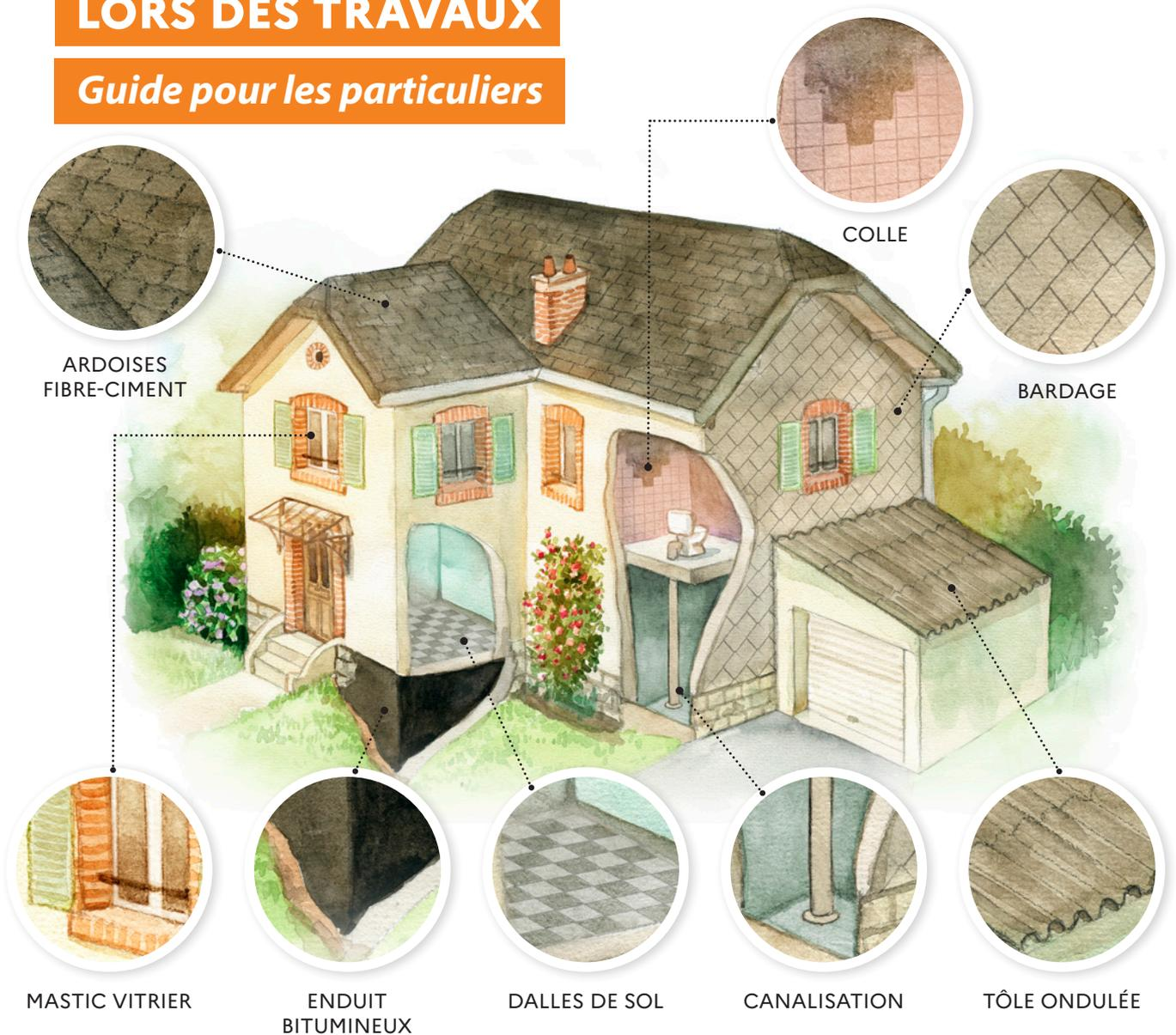
L'amiante a été interdit en 1997 mais reste aujourd'hui présent dans de nombreux composants de bâtiments construits avant cette date : toiture en ardoise artificielle, tôle ondulée, canalisations, dalle de sol en vinyle...
