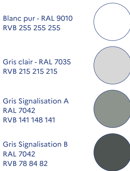
Figure 13 Échelle de gris: notes de 0 à 4 (0: blanc pur, 1: blanc de sécurité, 2: gris clair, 3: gris - signalisation A, 4: gris - signalisation B)
