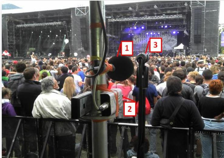
Position en parallèle des **microphones** des appareils de mesures engagés en façade de la régie « montagne » : **1.** sonomètre ARS, **2.** afficheur « Sensibel », **3.** analyseur de spectre.
